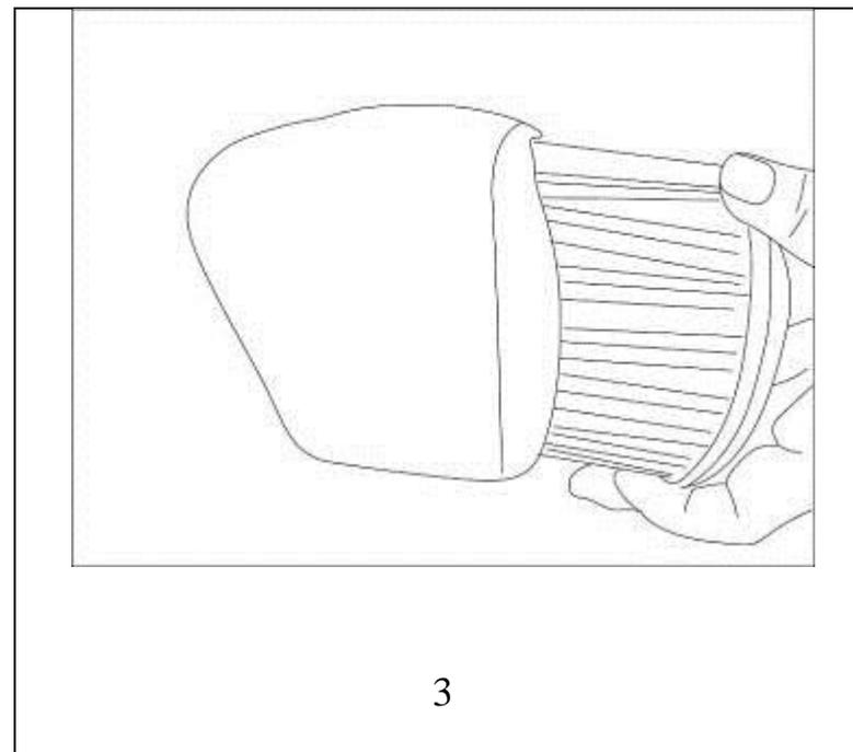
4. La cartouche de filtrage peut être rincée avec un tuyau d'arrosage et réutilisée. Cependant, si la cartouche de filtrage reste sale ou si elle est décolorée, elle doit être immédiatement remplacée.
