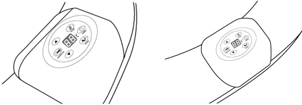
La base du contrôleur est fabriqué en matériau PU écologique doux et confortable. La surface de la base est lavable. Le contrôleur est plaqué chrome, et respecte la norme ROHS. Les films de protection sont collés sur le contrôleur avec de la colle marine.
