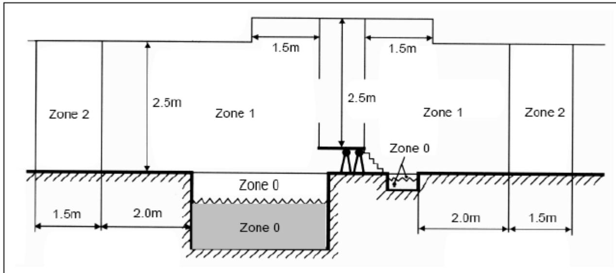
Remarque : Les dimensions de la zone mesurée sont limitées par les murs et les cloisons fixes. Figure ci-dessus—Dimensions des zones pour les piscines et les bassins.
